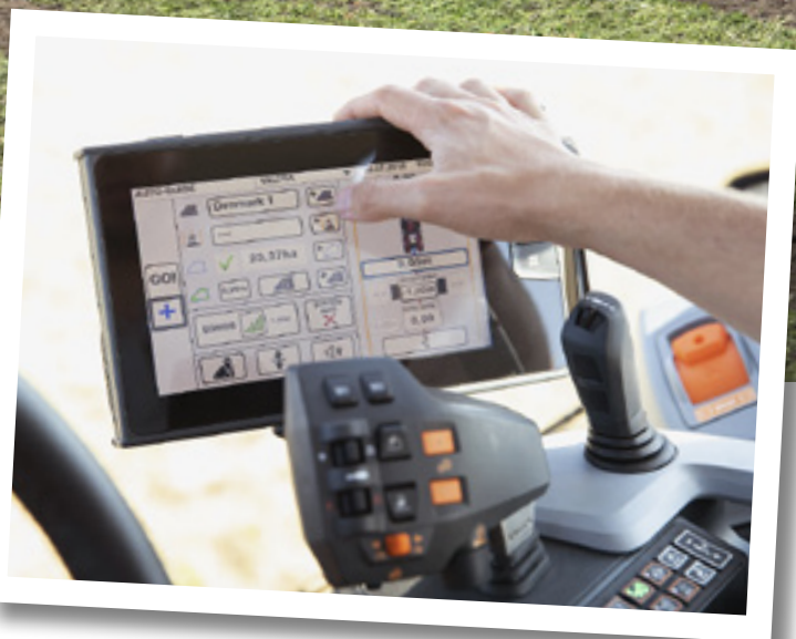
Auto-Guide représente une partie essentielle du concept d'exploitation de DanRoots. Les tracteurs et les récolteuses travaillent précisément sur les mêmes lignes.
